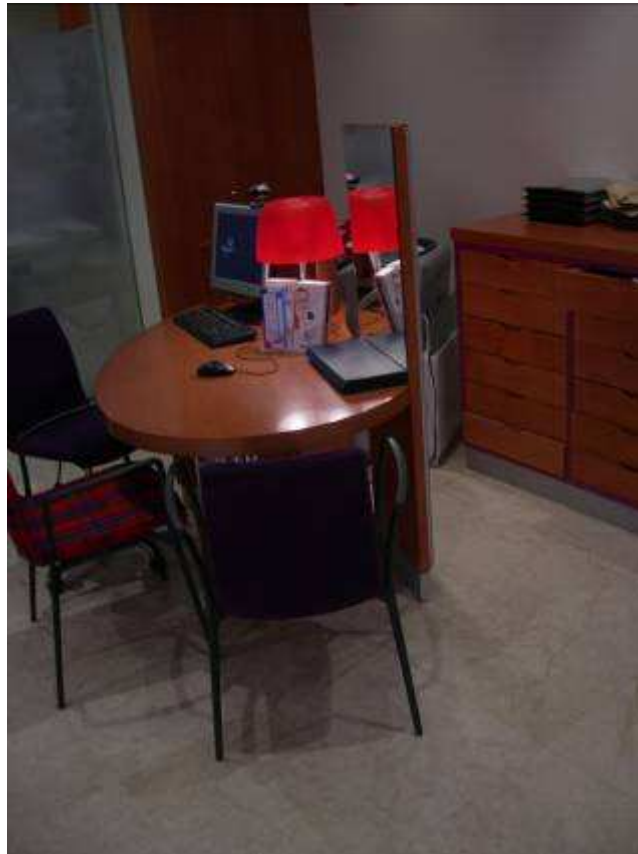
Figura 2.1.23 – Reflejos inconvenientes de la iluminación general; lámpara de mesa y espejo fijos, no movibles ni orientables
